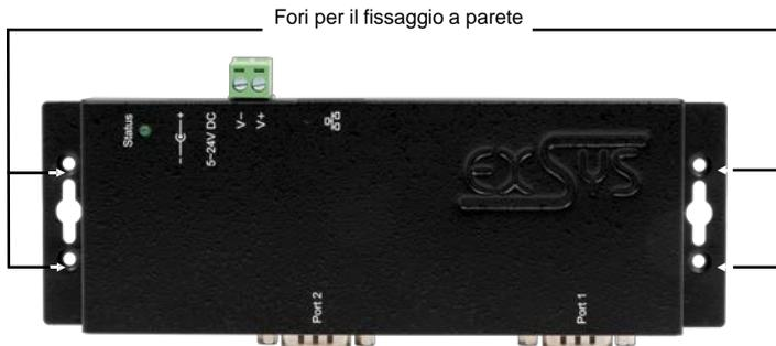
2. Collega EX-6122-2 alla rete utilizzando un cavo patch RJ45 Ethernet CAT.5/6.
