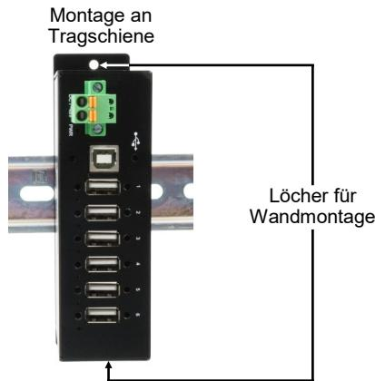
2. Verbinden Sie das mitgelieferte USB Kabel mit der USB Upstream B-Buchse des Hub's.
