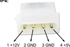
Um die EX-11087 zu betreiben, muss die Karte mit dem Stromanschluss vom PC-Netzteil verbunden werden!
