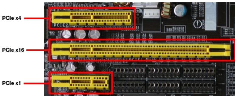
3. Stecken Sie nun die PCIe-Host-Adapterkarte in einen freien PCI-Express-Slot. Dabei spielt es keine Rolle ob es sich um einen x1, x4, x8 oder x16 Slot handelt. Nach dem Einstecken, können Sie nun das Blech der PCIe-Host-Adapterkarte an das Computergehäuse festschrauben.
