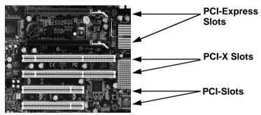
Stecken Sie die EX-3500 vorsichtig in den ausgewählten PCI-Express Slot ein. Beachten Sie, dass sie dabei korrekt eingesteckt wird, und dass kein Kurzschluss entsteht. Bitte wenden sie in keinem Fall Gewalt an. Die Karte sollte sich mit leichtem druck in den Port einsetzen lassen! Danach befestigen Sie die Karte mit einer Schraube am Gehäuse. Sie können das Computergehäuse nun wieder schließen und die Netzverbindungen wieder herstellen!
