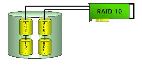
gehen 50 Prozent der Gesamtkapazität für die Redundanz verloren. RAID 0+1 ist am besten für Systeme mit kleinerer Nutzkapazität geeignet, bei denen optimaler Datendurchsatz mit Datensicherheit verknüpft werden soll. Die Datensicherheit ist jedoch durch die verschachtelung
