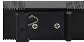
Per installare il supporto a parete, il kit guida DIN deve essere sostituito dalla staffa di montaggio
